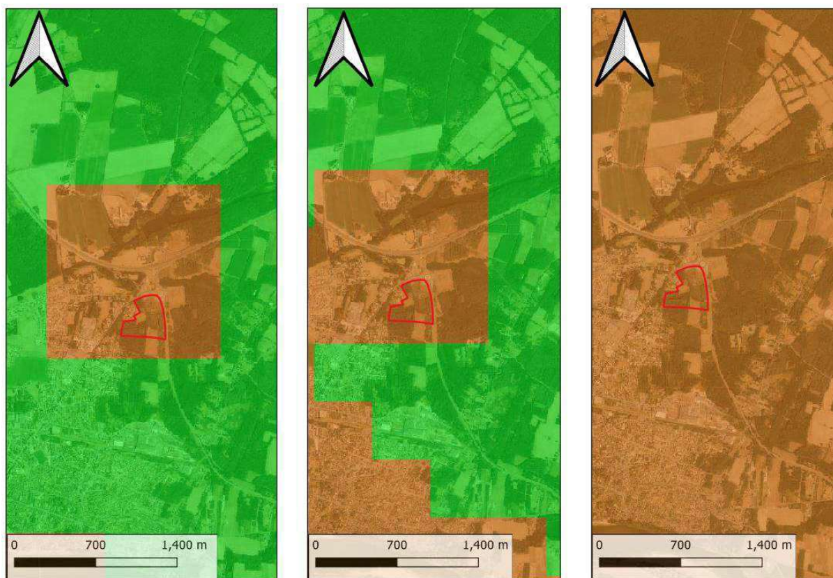
Figure 12 : Zonage réglementaire pour les échangeurs ouverts ou fermés de 0 à 50 m à gauche, de 50 à 100 m au centre et de 100 à 200 m à droite (géothermie perspective)
